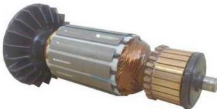
Obr. 4-4 Pohled na komutátor s prořezanou mezi lamelovou izolací
