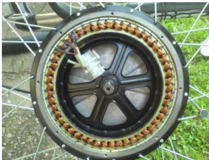
Bezkartáčový BLDC motor s elektronickým komutátorem a buzením PM ze vzácných zemin NdFeB
