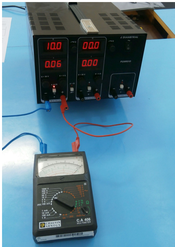
Tabulka 1. Základní měření stejnosměrného napětí. Napětí zdroje U_z=10\text{ V} .
